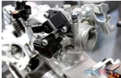
Gambar 6.30 Konstruksi IAP sensor
