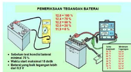
Gambar 5.19 Pengukuran tegangan pengisian
