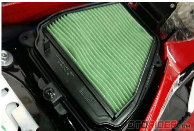
Gambar 6.18 Saringan udara jenis viscous
