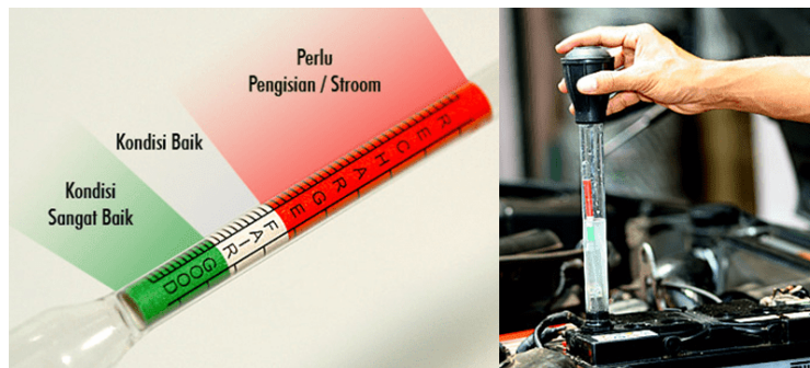
Gambar 1.63 Cara penggunaan hidrometer
