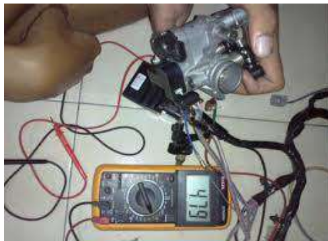
Gambar 6.19 Pemeriksaan output voltage TP sensor sistem injeksi YMZ FI
