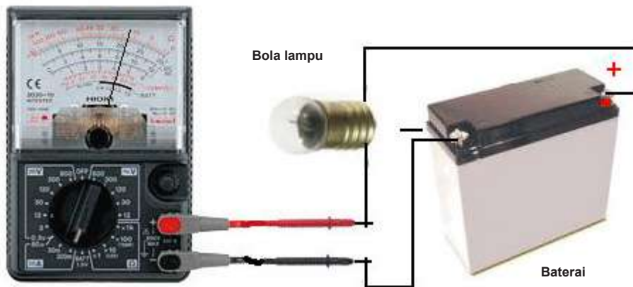
Gambar 1.59 Cara mengukur arus listrik DC
