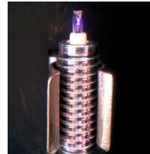
Sumber: https://zonabikers.com (7/06/2019) Gambar 4.3 Bentuk letikan bunga api elektroda busi
