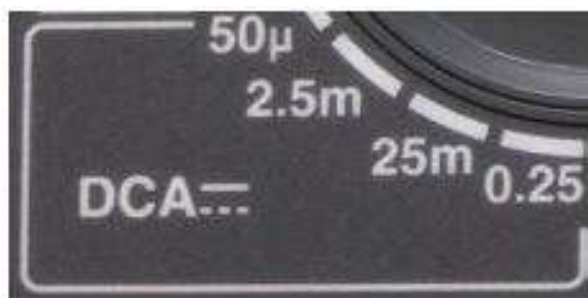
Gambar 1.58 Rentang selektor arus listrik DC
