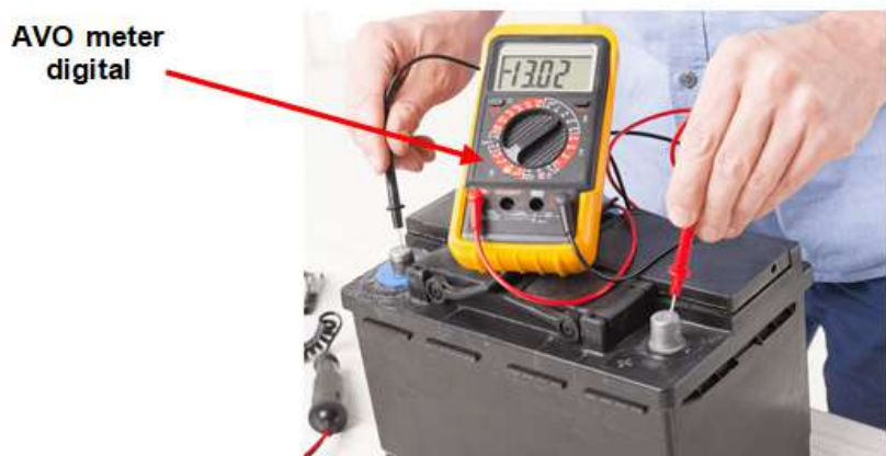
Gambar 4.44 Pemeriksaan kapasitas tegangan baterai
