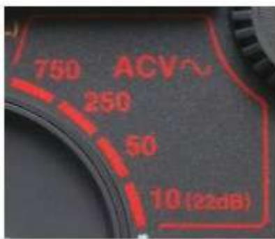
Sumber: https://panduanteknisi.com (15/10/2019) Gambar 1.54 Rentang selektor tegangan listrik AC volt
