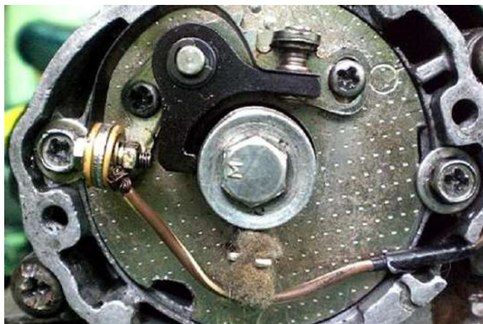
Gambar 4.16 Kontak poin/platina sistem pengapian sepeda motor
