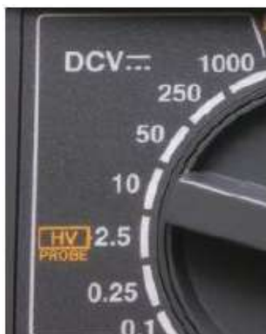
Gambar 1.56 Rentang selektor tegangan listrik DC volt
