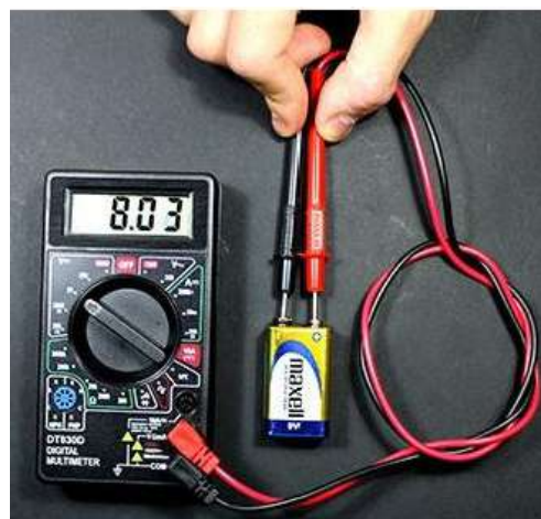
Gambar 1.57 Cara mengukur tegangan listrik DC volt
