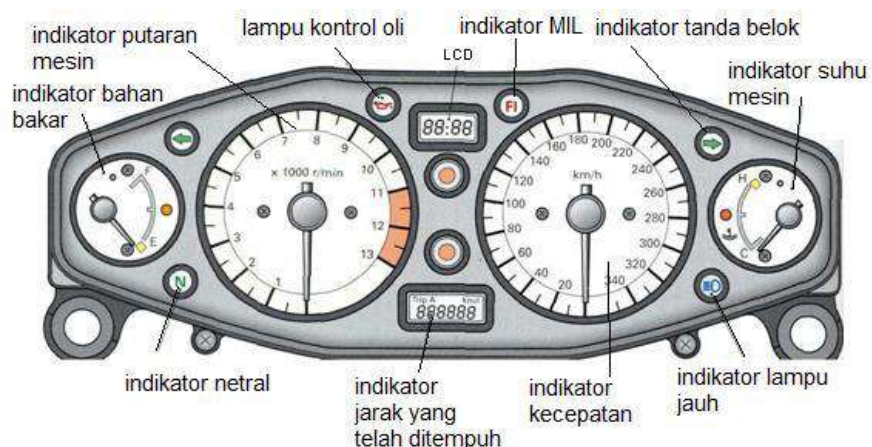
Gambar 5.8 Rangkaian panel lampu sepeda motor
