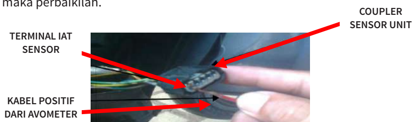
Gambar 6.59 Pengukuran tegangan IAT pada konektor
