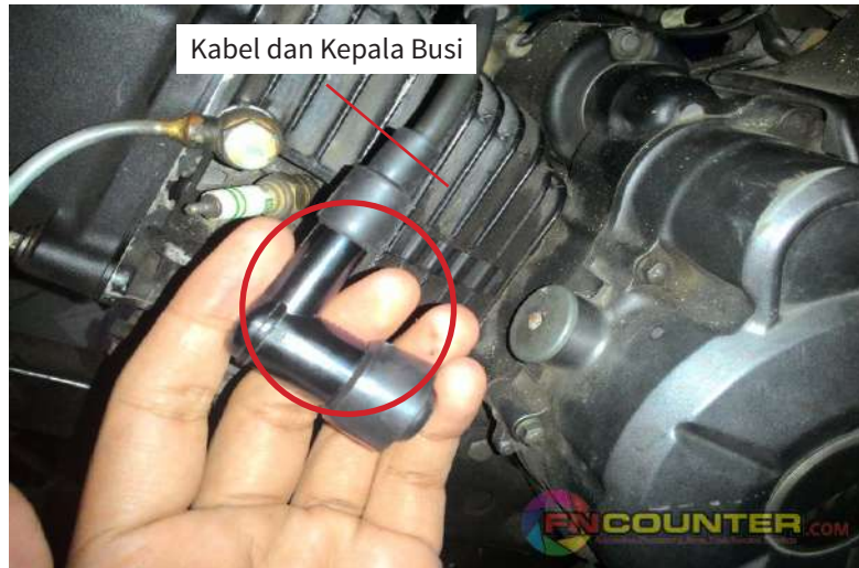
Gambar 4.17 Kabel busi sekaligus kabel tegangan tinggi
