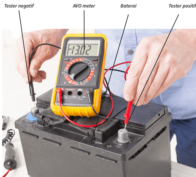
Gambar 2.36 Pemeriksaan tegangan pada terminal baterai
