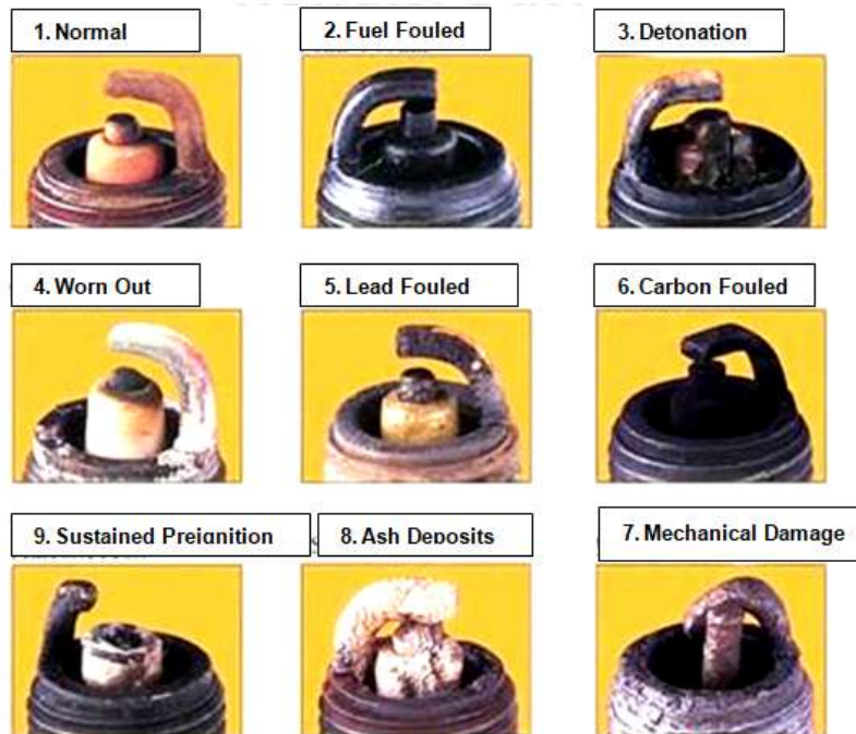
Gambar 4.61 Warna hasil pembakaran pada busi
